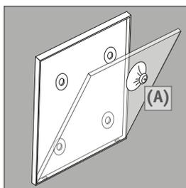
(1) Die Deckplatte (Acryl-Glas entspiegelt, 3 mm) mit Hilfe des Saugers abziehen.
