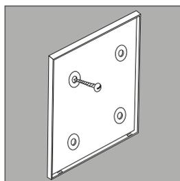
(2) Nun kann das Schild nach dem Setzen der Dübel angeschraubt werden.
