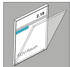
(4) Die Deckplatte zuerst unten, bei den eingedrückten Klemmen, einlegen und anschließend die Scheiben an der oberen Seite fest eindrücken.
